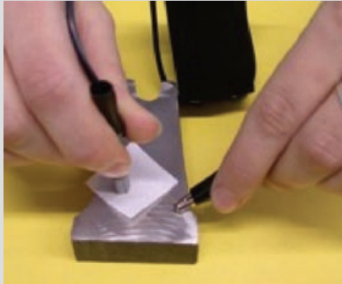
Existen métodos electroquímicos de ensayos para averiguar si un tipo de acero inoxidable contiene molibdeno (izquierda) o no (derecha).
