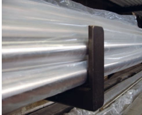
Los elementos deben estar protegidos para evitar daños y contaminación durante el almacenamiento, manipulación y transporte.
