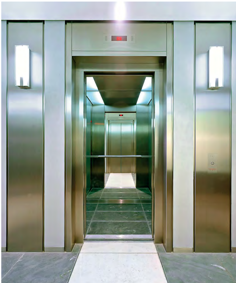
Acero inoxidable ferrítico EN 1.4016 con un acabado rolled-on similar a los acabados esmerilados clásicos. Fotografía: ThyssenKrupp Nirosta, Krefeld (Alemania)
