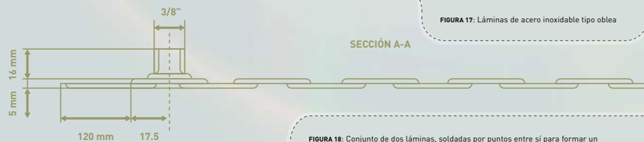
FIGURA 18: Conjunto de dos láminas, soldadas por puntos entre sí para formar un absorbidor tipo laminar.
