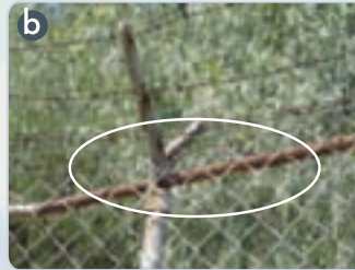
Malla de acero galvanizado con muestras de corrosión
