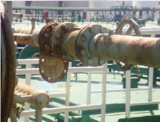
Tubería y tanque de almacenamiento afectados por corrosión
