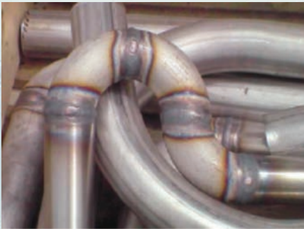
Manchas por calentamiento de soldadura
