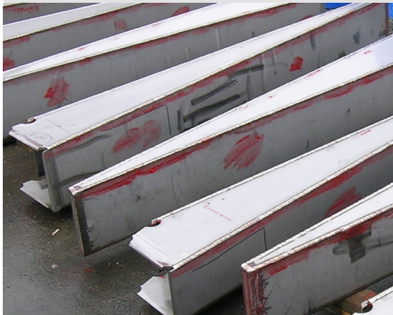
Figura 7: Aplicación de la pasta de decapado sobre las áreas soldadas para eliminar óxidos y contaminantes
