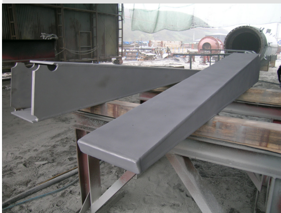
Figura 8: Acabado superficial de los miembros estructurales
