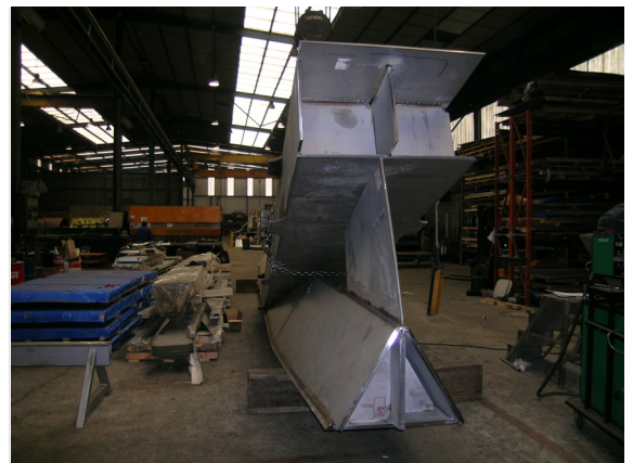
Figure 5: Placa celular de acero entre el arco y la viga longitudinal
