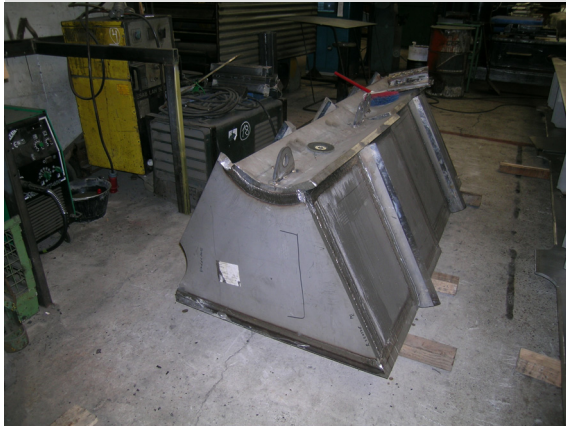
Figura 6: Cojinete de apoyo
