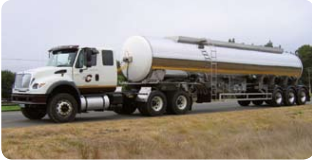
Camión sistema de leche, chapado con 430, Sudáfrica.
