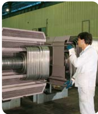
Recalentador de vapor, separador de humedad, tipo 409, Europa.
