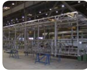
Tubos soldados y panel de tipo 1.4003, Solaris Bus & Coach Co., Polonia
