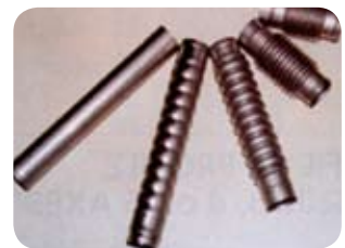
Doblado de un tubo soldado 439 Ti.
