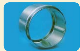
Tambor de secadora: lámina soldada 409, formada por expansión
