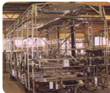
Bastidor de carrocería de autobús, tipo 410, Sudáfrica.
