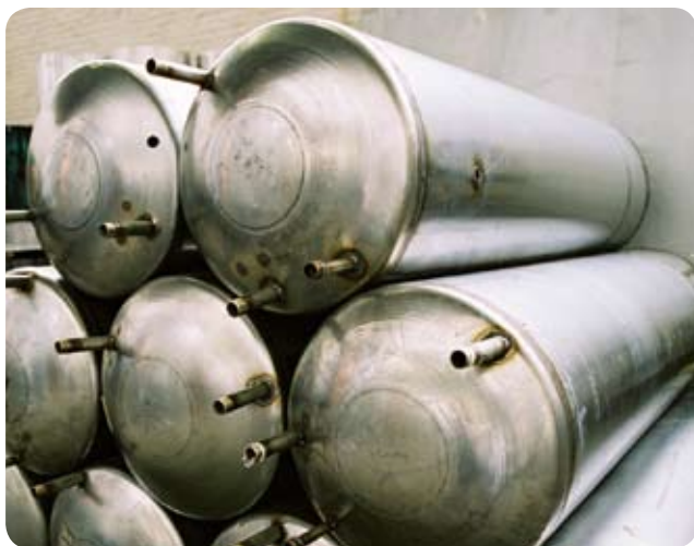
Parte superior e inferior de calderas estampadas, tipo 441, Sudáfrica.
