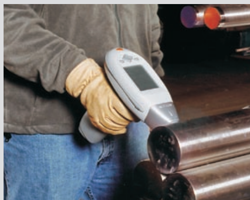
Para un análisis completo de la aleación, existen dispositivos manuales especiales que indican su composición química.
