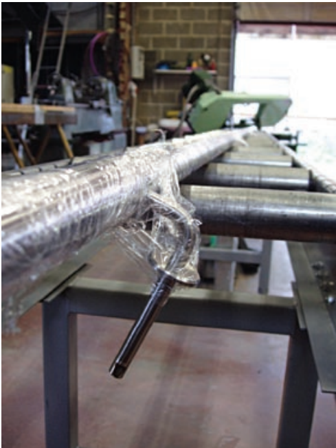
El embalaje plástico protege las secciones huecas del acero inoxidable frente a la acumulación de hierro proveniente de los estantes de acero al carbono.
