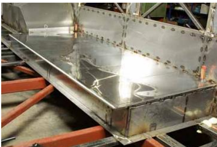
Figura 52.- Un elemento de piso panel sándwich experimental de autobús, en el grado 1.4003, ensamblado utilizando soldadura láser (Alenius et al. 2002).
