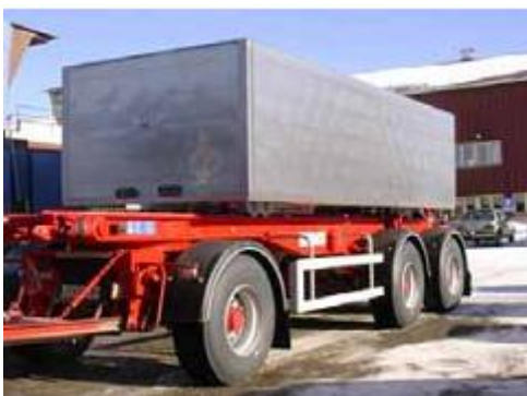
Figura 53. Paneles sándwich de Acero inoxidable se utilizan como elementos laterales y de piso de una plataforma de remolque de grava de un trailer (Kenno Tech 2008).
