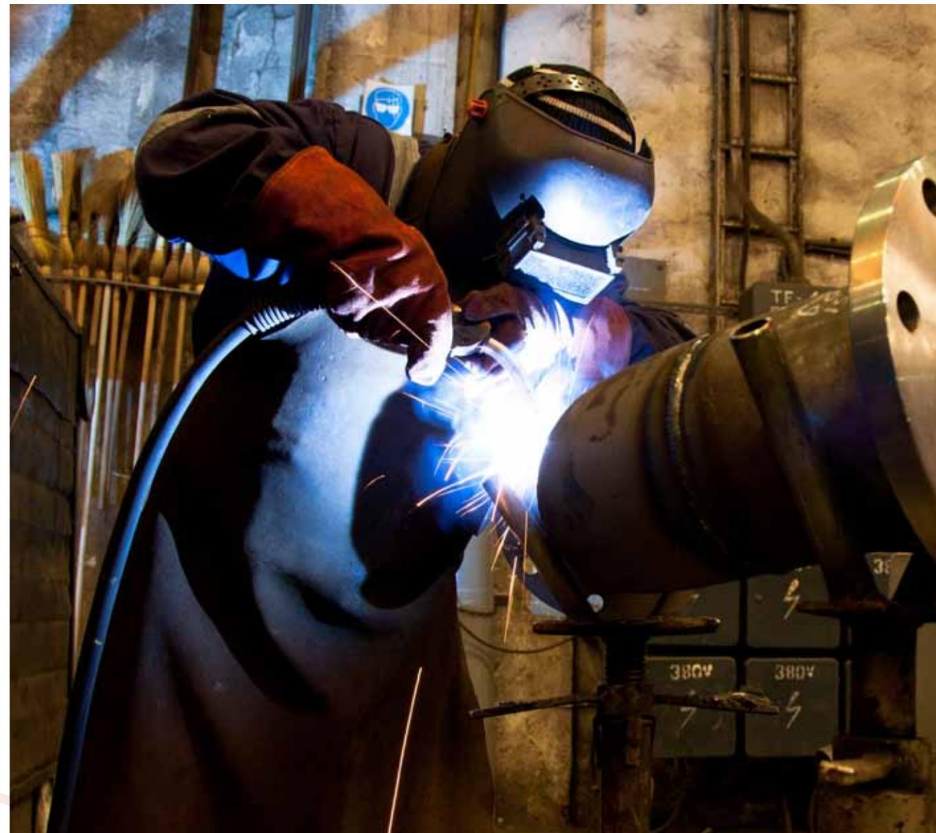
**Proceso GMAW o MIG, arco eléctrico con alambre continuo y protección gaseosa**
