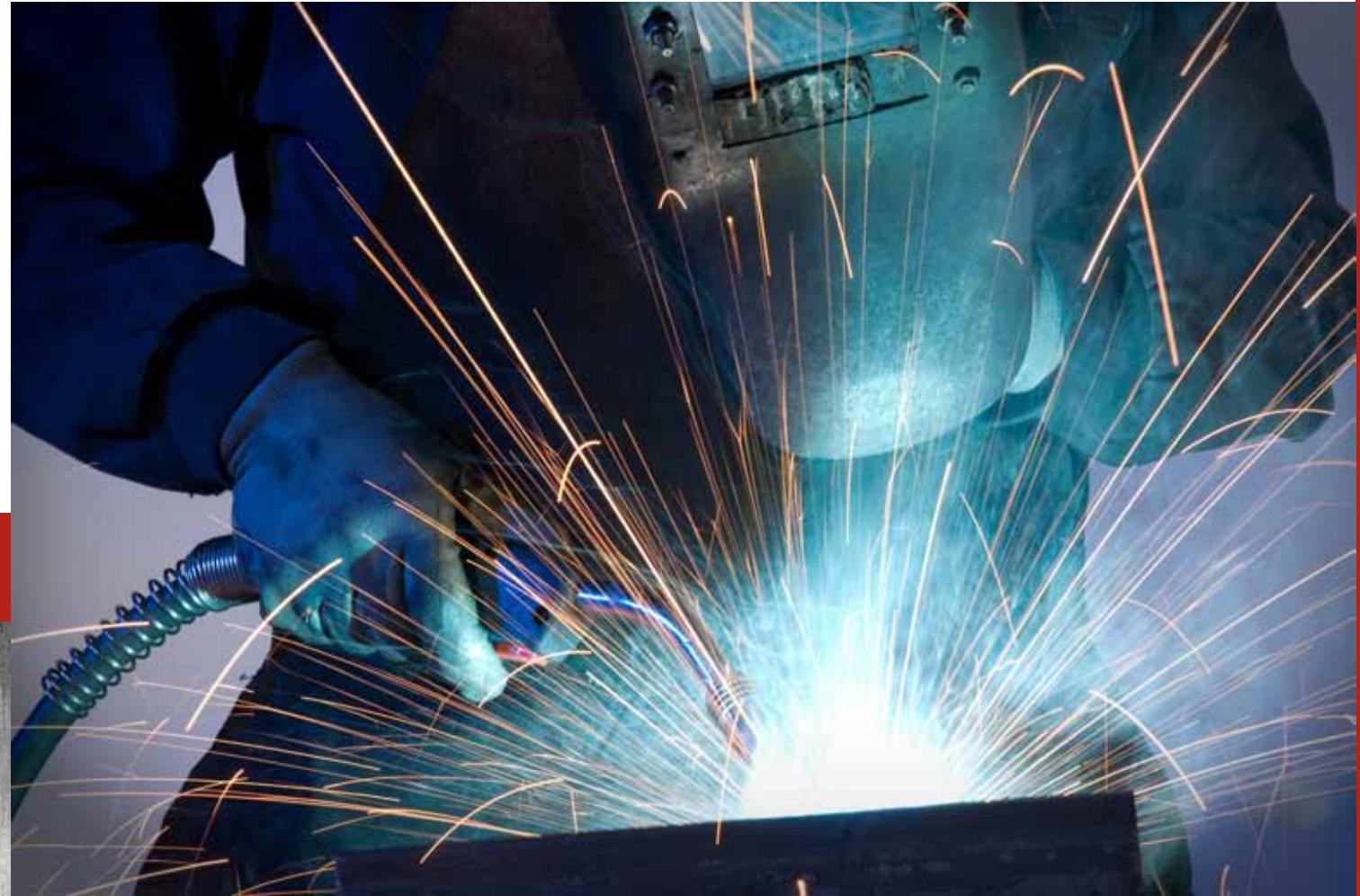
Soldadura es la unión mediante la acción de calor de una o más piezas con la finalidad de formar una junta que brinde o proporcione un área continua. Es, sin lugar a dudas, el método más utilizado para unir los aceros inoxidable.
