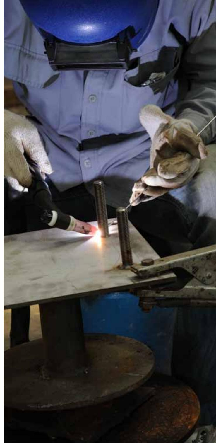
También se recomienda usar gases de protección de argón puro o mezclas de argón y helio; las mezclas de argón e hidrógeno implican riesgo de fragilización por hidrógeno en la junta soldada. El nitrógeno se debe evitar.
