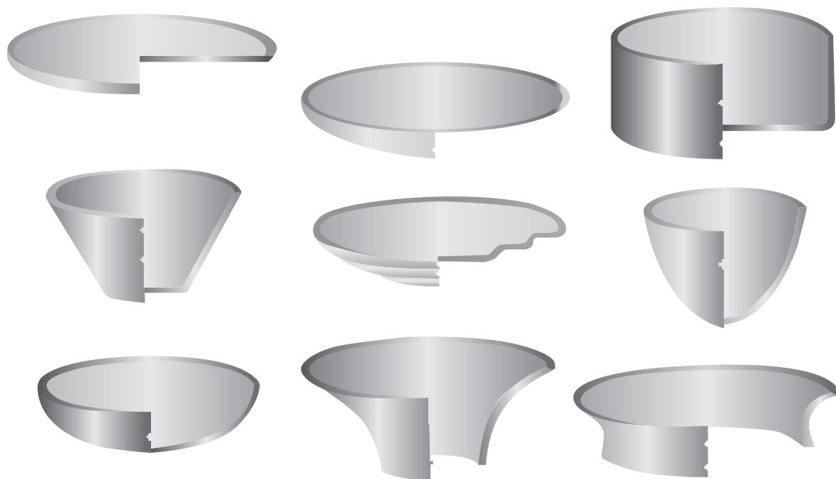
Formas típicas cónicas, cilíndricas y de domo realizadas por rechazado
