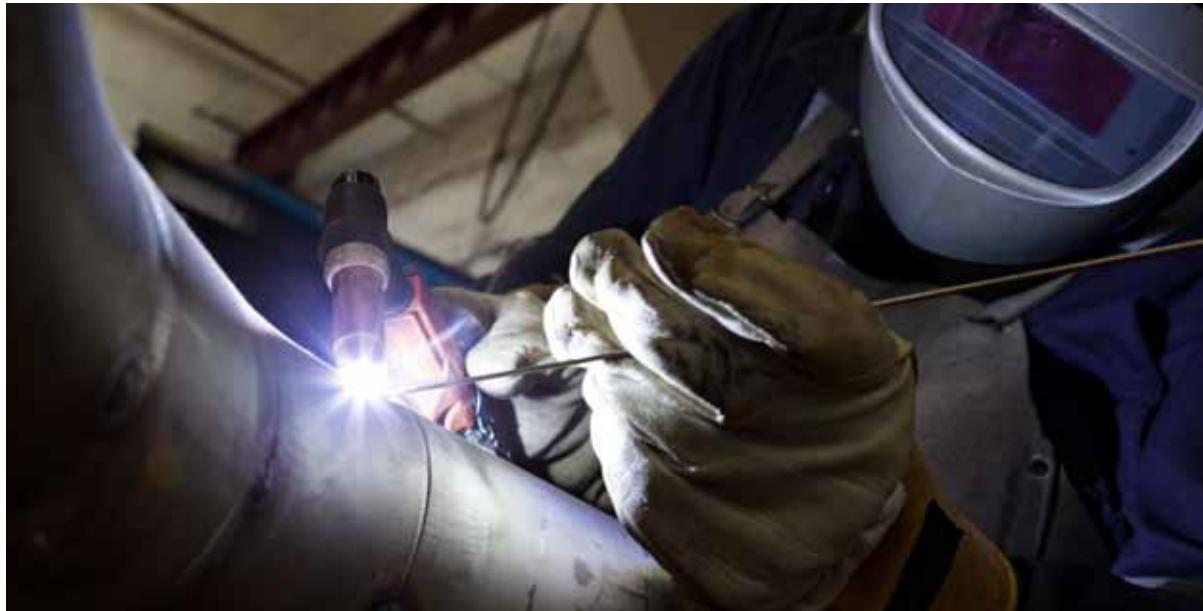
La soldadura por arco con electrodo de tungsteno y gas (TIG) es un proceso en el que la soldadura se logra por el calor de un arco establecido entre un electrodo no consumible de tungsteno y la pieza de trabajo. El electrodo, el arco y el área vecina al charco de metal líquido son protegidos por una pantalla de gas inerte. El electrodo
