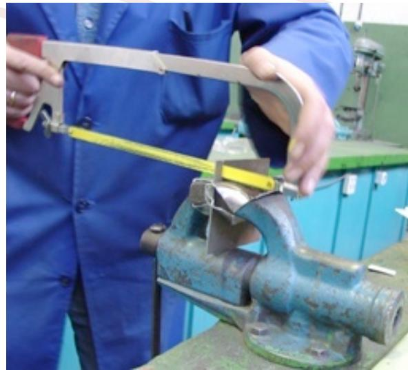
En las sierras de arco manuales y mecánicas se utiliza una acción cortante alternativa en la hoja, la cual está montada para alternar (reciprocarse) en un plano horizontal.
