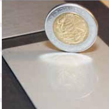
Por ejemplo, el acabado 2B (superficie reflectante, aunque ligeramente mate) es excelente para aplicaciones en exteriores, donde el agua de lluvia hace la limpieza; pero no para interiores, porque las huellas dactilares resultan muy evidentes.
