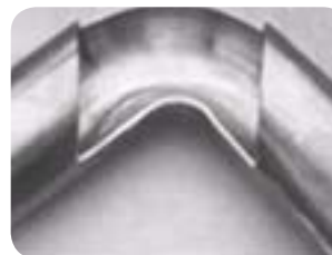
Doblado de un tubo soldado 439 Ti.
