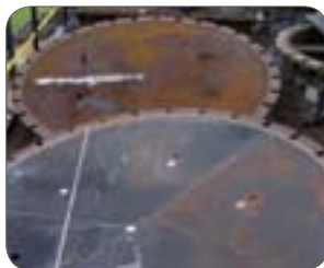
Grado 1.4003/410, Columbus, Sudáfrica. Acero al carbono (parte superior) comparado con acero ferrítico (parte inferior) tras 6 años de servicio.
