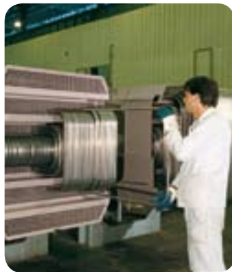
Recalentador de un separador de humedad, tipo 439, Europa.
