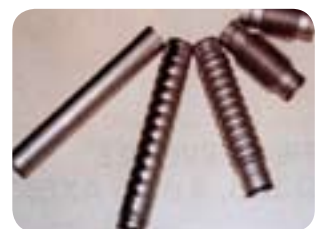
Doblado de un tubo soldado 439 Ti.
